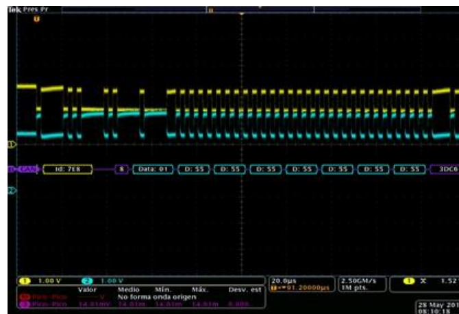
Fig. 11. Fragmento de trama enviada, donde el primero dato es 0x01, siendo este, el que procesa y representa el PIC en los leds.
