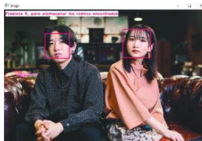
Fig. 6. Uso de la librería MediaPipe para reconocer rostros automáticamente.
