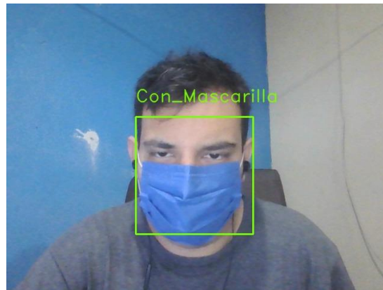
Fig. 10. Resultado del sistema cuando detecta que se utiliza el cubrebocas.
