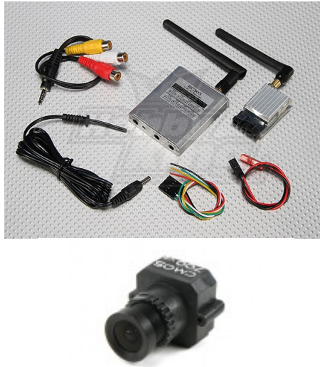
Fig. 4. Sistema de video para el prototipo CanSat
